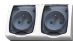
GNH-2NZP/00/d komplet 2 zásuvek IP 44, 16 A s průhledným víčkem s dětskou ochranou
