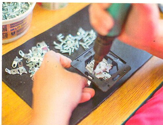
Montáž strojků i dalších komponentů domovních vypínačů se na dílnách dělá ručně
